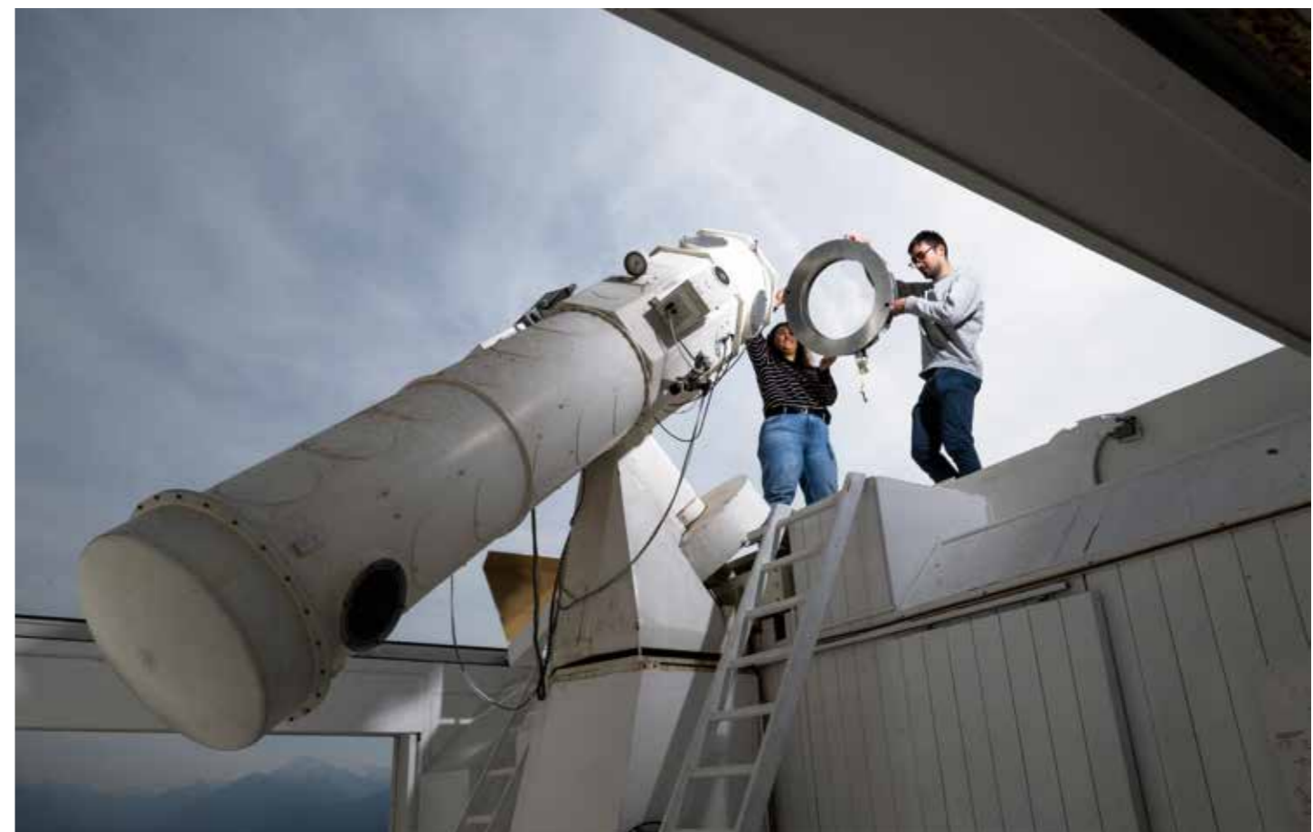
❖ Uno strumento speciale per misure di polarizzazione viene fissato di fronte al telescopio.
